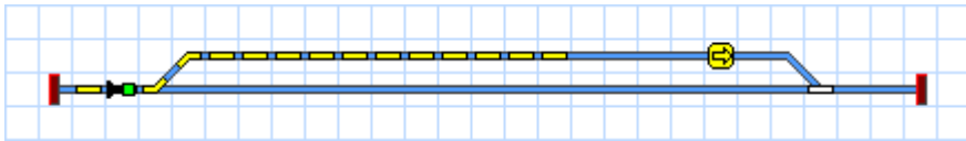
Abbildung 151: Aktive Weichenstraße im Stellwerk mit Weiche und Signal
